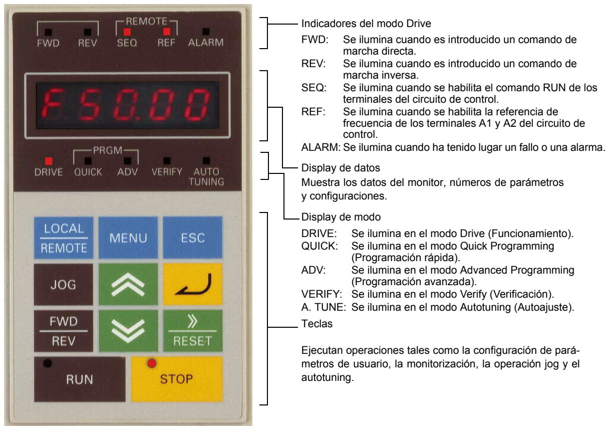
Fig. 3.1 Nombres y funciones de los componentes del operador digital de LED
