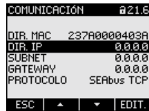
Figura 3-8 Parámetro ajustable "Comunicación"
